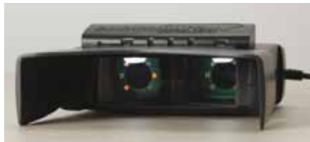
يلتقط جهاز I SCAN ٢ صور القرحة في أقل من عشر ثوانٍ ويؤثر أقل من رطل واحد
