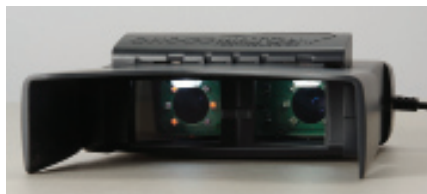
I SCAN 2 captura imágenes de iris en menos de diez segundos y pesa sólo medio kilogramo
